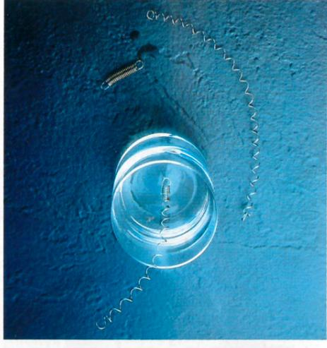
Herstellung solcher Materialien für die breite Anwendung zu kostspielig. Dank einer Biegeprozedur kann nach Angaben von Beta Phase mittlerweile wiederholt werden, ohne daß Nitinol Ermüdungserscheinungen zeigt. Aus Nitinol lassen sich nicht nur Brillenbügel herstellen, sondern auch Spiralfeder und spezielle Steckkontakte für elektronische Geräte. Auch die Spi-
